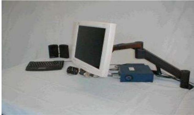
FIGURE 1 : DIRECT-SELECT-VISION-CONTROLLED COMMUNICATION AND CONTROL SYSTEM
